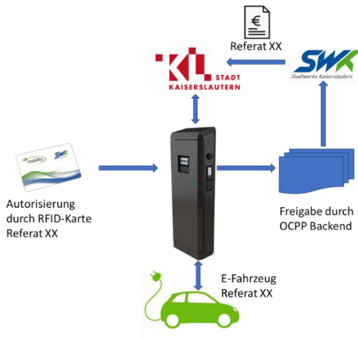
Abbildung 41: Ladevorgang an interner Ladeinfrastruktur
